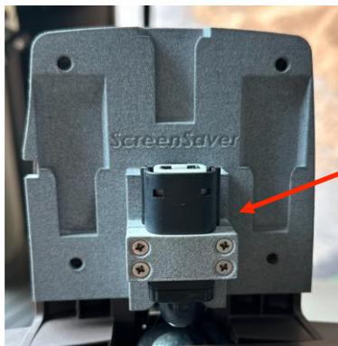
Placez la prise avec le loquet de verrouillage contre la platine de l'accoudoir, puis positionnez le support de prise pour la verrouiller.
