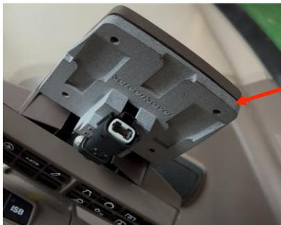
Positionnez la platine sur l'accoudoir comme indiqué sur la photo à gauche. Utilisez les quatre vis Torx que vous avez démontées précédemment pour fixer la platine.
