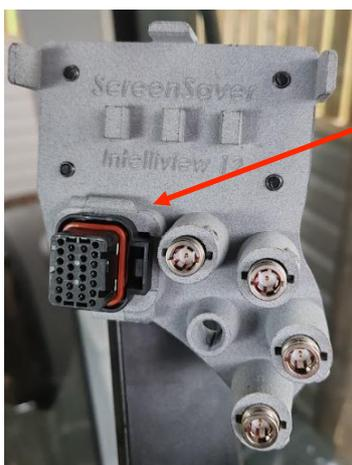
Placez la prise avec le loquet de verrouillage à droite, puis positionnez le support de prise pour la verrouiller.
