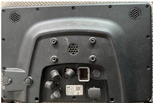
1. Procéder ensuite au démontage des protections des prises caméra. Une fois les protections des prises caméra démonté, procédez à la fixation de l'axe de centrage à l'aide des 4 vis Torx M2,5.
