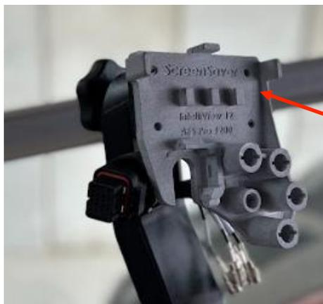
Replier la protection en caoutchouc de la prise d'alimentation principale et récupérer environ 4 à 5 cm de la longueur du faisceau de la caméra pour faciliter l'installation des prises de la caméra.
