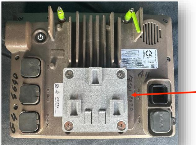
**Démontez le support:** Retirez le support situé à l'arrière de votre console. Veillez à bien conserver la visserie, car elle vous sera nécessaire pour la fixation de la platine côté tracteur (étape 2).
